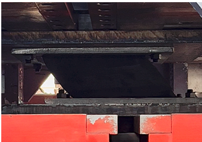
Fig. 14. Horizontal shear test (10 MPa-200 % \gamma ).
