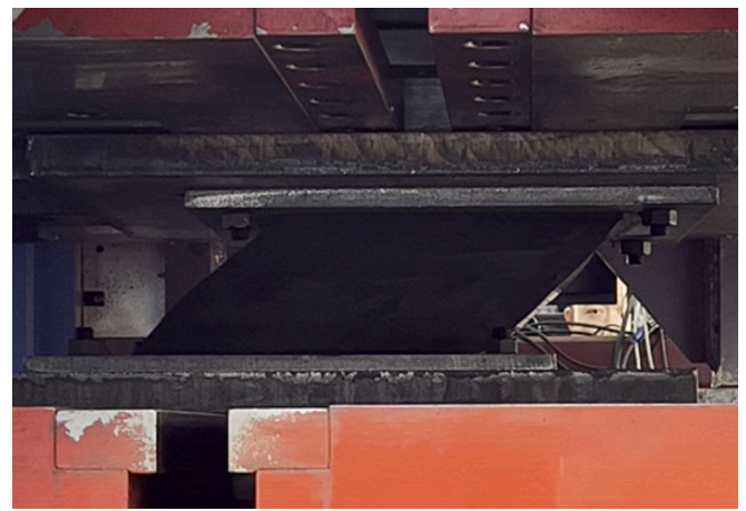
Fig. 17. Horizontal shear test (5 MPa-300 % \gamma ).
