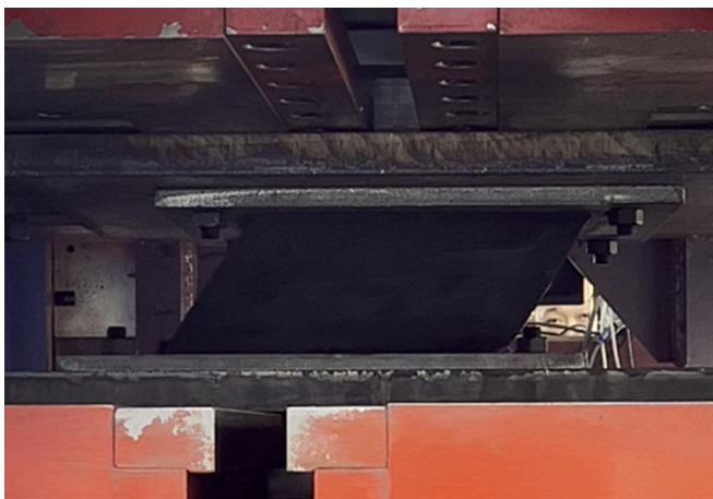
Fig. 13. Horizontal shear test (5 MPa-200 % \gamma ).
