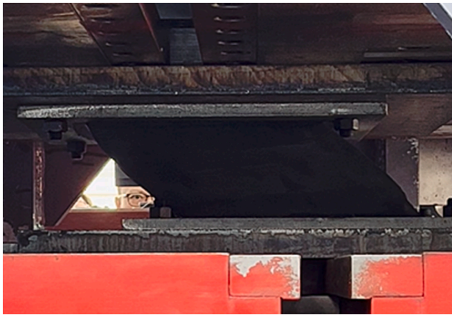
Fig. 18. Horizontal shear test (10 MPa-300 % \gamma ).
