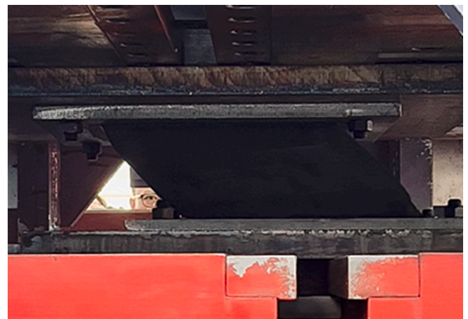
Fig. 16. Horizontal shear test (10 MPa-250 % \gamma ).
