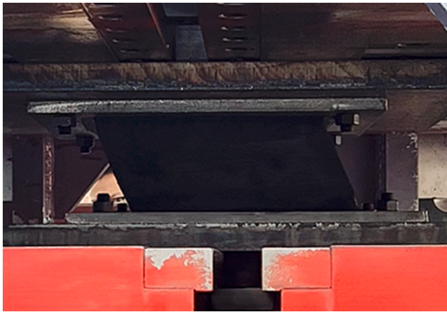
Fig. 12. Horizontal shear test (10 MPa-100 % \gamma ).
